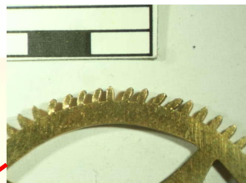
Corrosion par fatigue, © M. Daval
