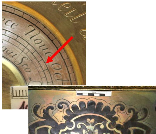
Corrosion généralisée (ternissement sur argent, © E. Cornet & irisation sur laiton, © M. Daval)
